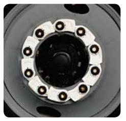
Si les verrous sont installés correctement, l'ensemble forme un cercle régulier indiquant que tous les écrous sont en place.
