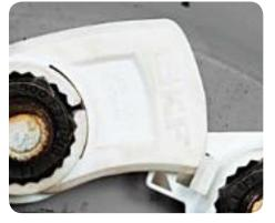
Si un écrou de roue se desserre, le verrou tourne et indique clairement que l'écrou doit être resserré.
