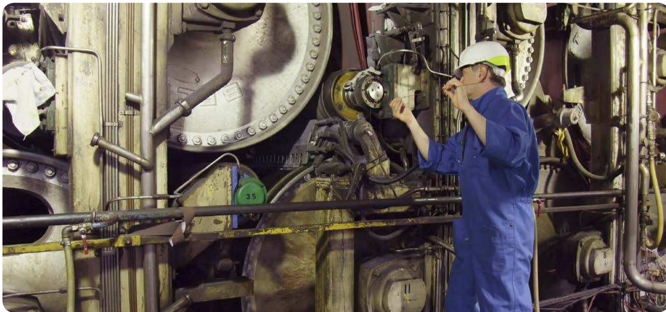
Philippe Gachet utiliza un trozo de alambre para comprobar la condición del camino de rodadura en un rodamiento de rodillos de fieltro.
