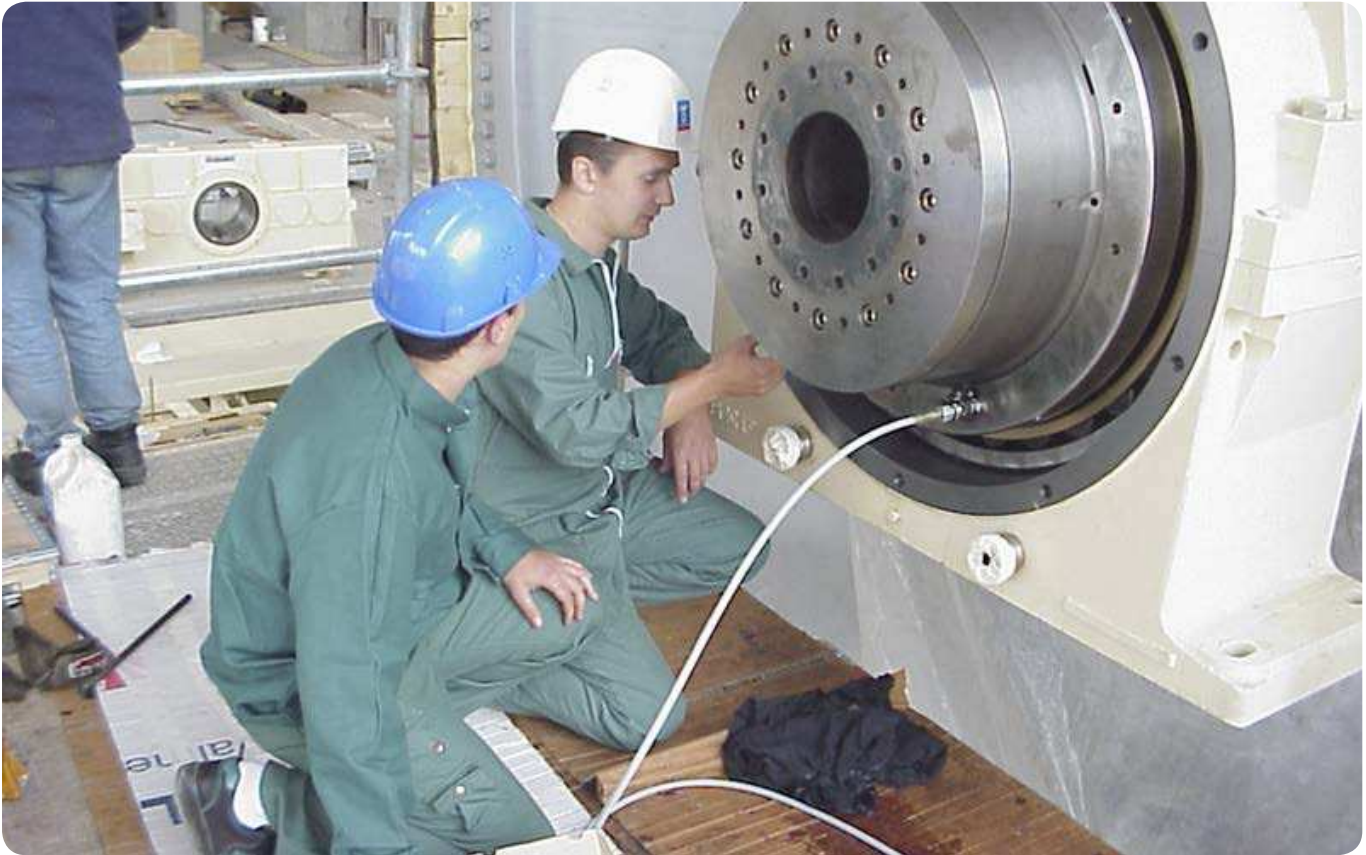
Montaje de rodamiento de rodillos toroidales CARB en un cilindro Yankee mediante el método de calado de rodamientos SKF Drive-up
