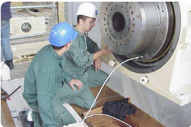
Fig. 8 Un rodamiento de rodillos toroidales CARB, montado con el método de calado de rodamientos SKF Drive-up, en un cilindro Yankee en Delipapier, Francia, en 1999. El ingeniero de SKF controla el desplazamiento axial del rodamiento, indicado por el reloj comparador que puede verse en la fig. 9.
