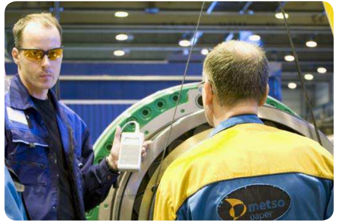
Fig. 3 Eerikki Makinen, Director de Ingeniería de Aplicaciones de SKF Finlandia, explicando el procedimiento de montaje del rodamiento de rodillos toroidales CARB con SensorMount.
