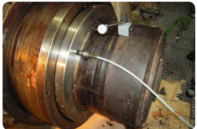
Fig. 1 Desplazamiento axial del manguito de fijación.
