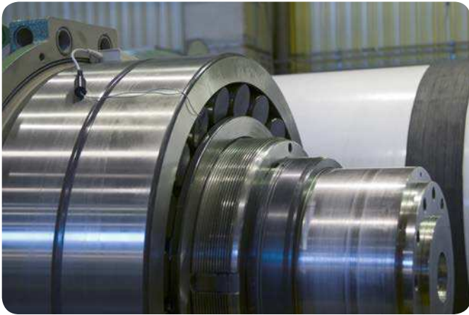
Fig. 6 Del otro lado, el rodamiento de rodillos a rótula también es apto para el montaje con SensorMount.
