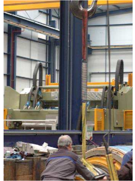
Fig. 5 Utilización de un muelle para simplificar la manipulación durante el montaje o las pruebas con azul de Prusia
