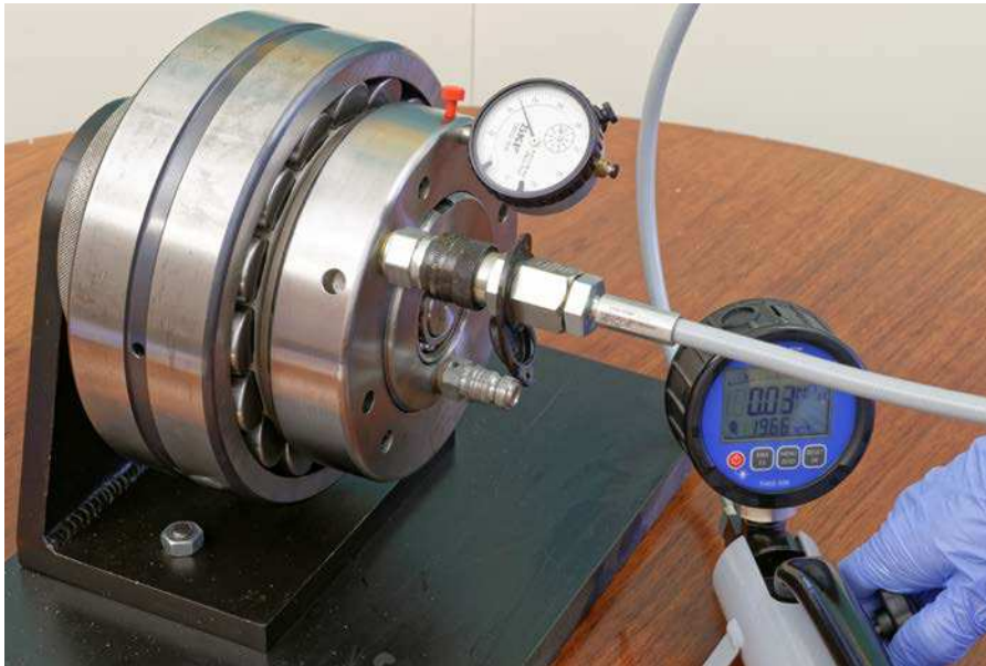
Figura 16 La aguja del reloj comparador retrocede cuando se libera la presión de aceite
