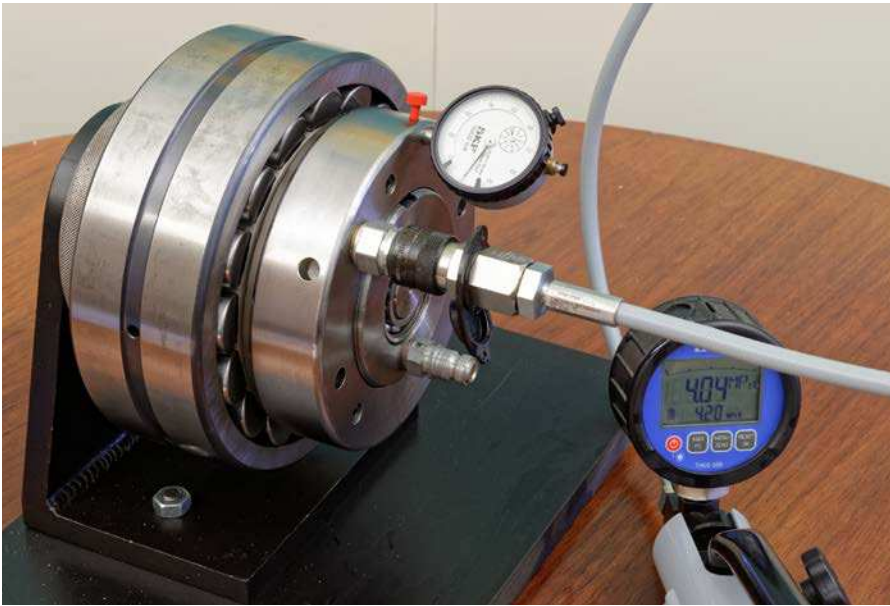
Fig. 12 Fije el reloj comparador en cero
