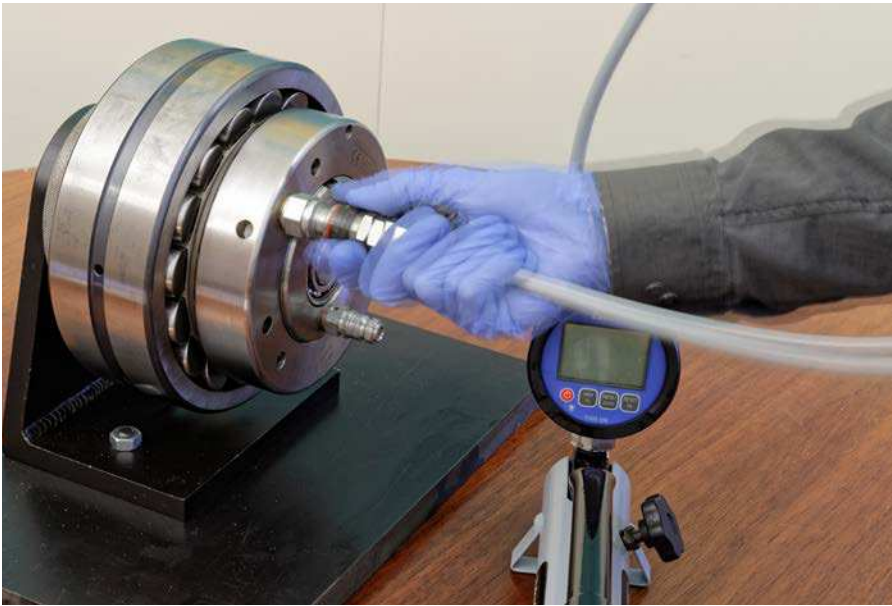
Fig. 7 Conecte la bomba a la tuerca hidráulica
