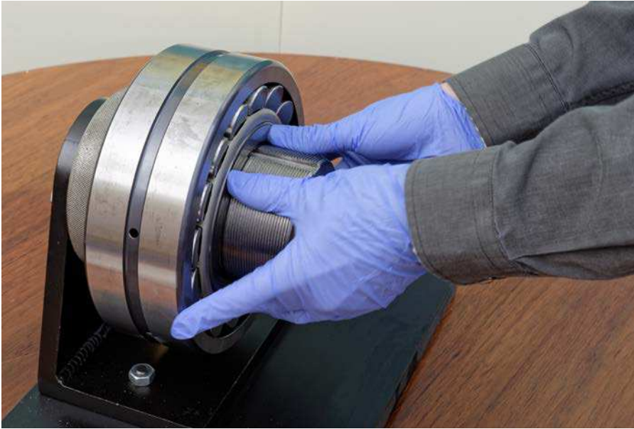
Fig. 4 Coloque el rodamiento sobre su asiento cónico
