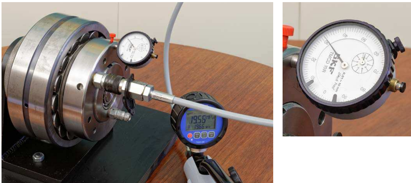
Fig. 14 Posición axial final alcanzada
