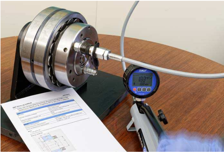
Fig. 9 Bombeo hasta obtener la presión de la posición inicial
