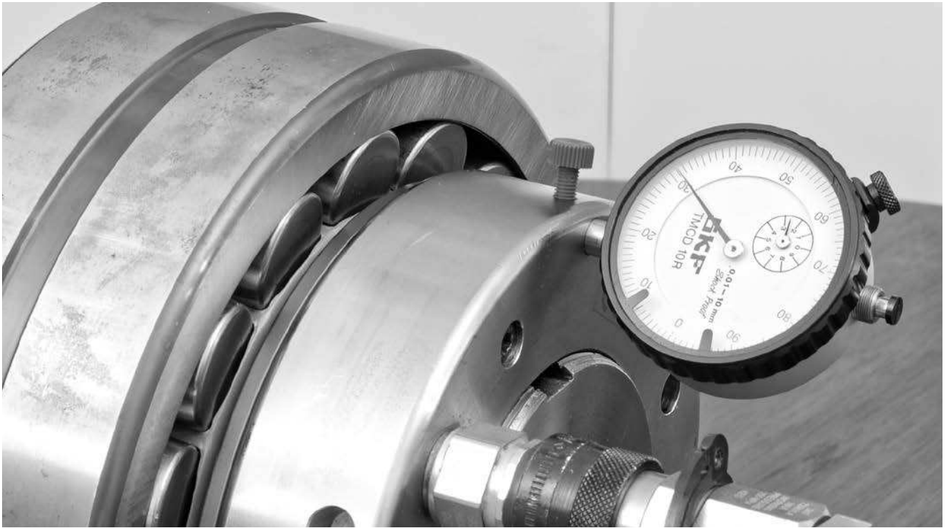
Las herramientas principales para el Método de calado de rodamientos SKF Drive-up: un reloj comparador y una tuerca hidráulica
