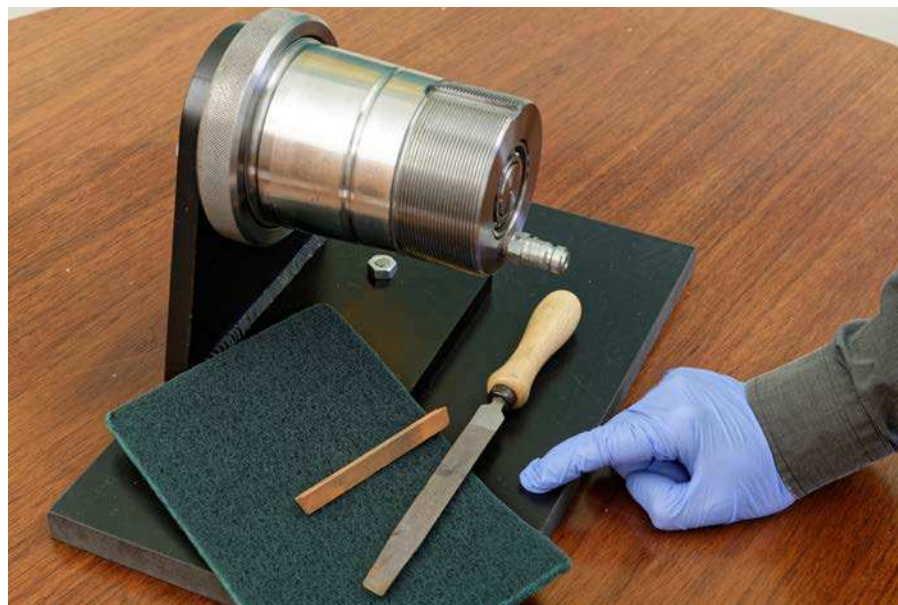
Fig. 2 Herramientas: esponja abrasiva, lima de acero, piedra de afilar y un dedo
