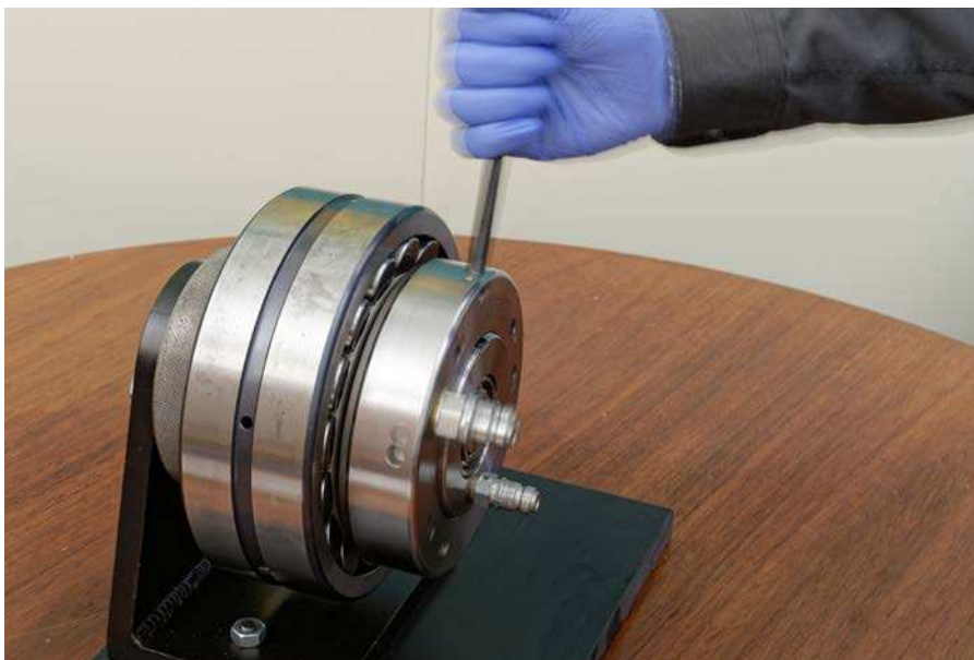
Fig. 6 Monte la tuerca hidráulica y apriétela manualmente
