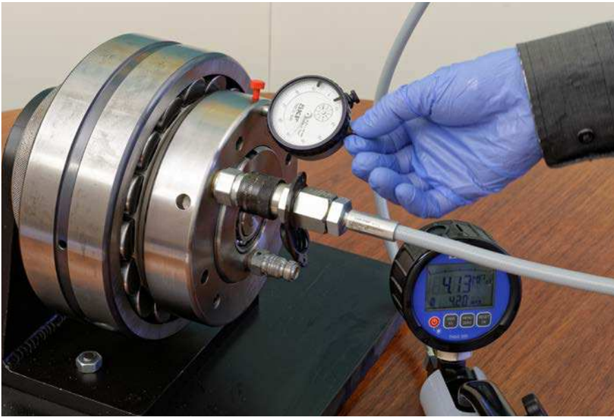
Fig. 11 Coloque el reloj comparador en la tuerca hidráulica de manera que pueda seguir el desplazamiento axial del rodamiento hasta que se alcance el valor final de calado
