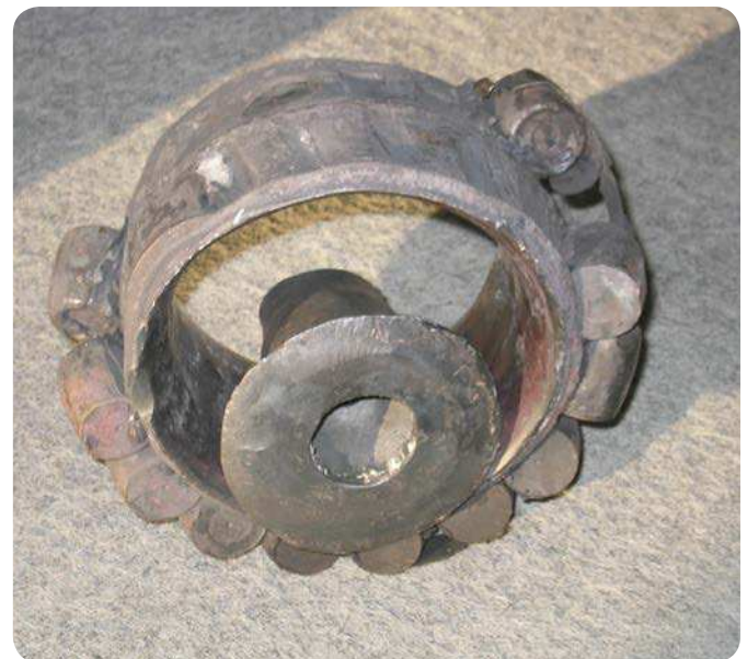
Fig. 2 Rodamiento demasiado dañado para diagnosticar la probable causa de falla. La parte que se ve en el medio es lo que queda del eje que soportaba el rodamiento.
