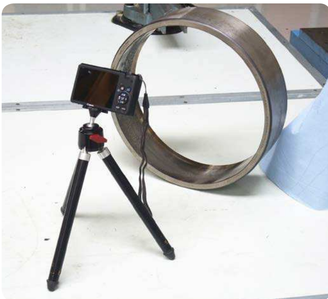
Fig. 12 Una cámara compacta sobre un trípode es, por lo general, lo suficientemente buena para tomar fotos razonables de rodamientos dañados.
