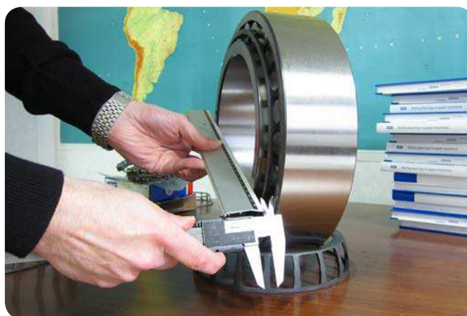
Fig. 8 Uso de una regla y un calibre vernier para medir el descentramiento axial II del aro interior frente al del aro exterior.
