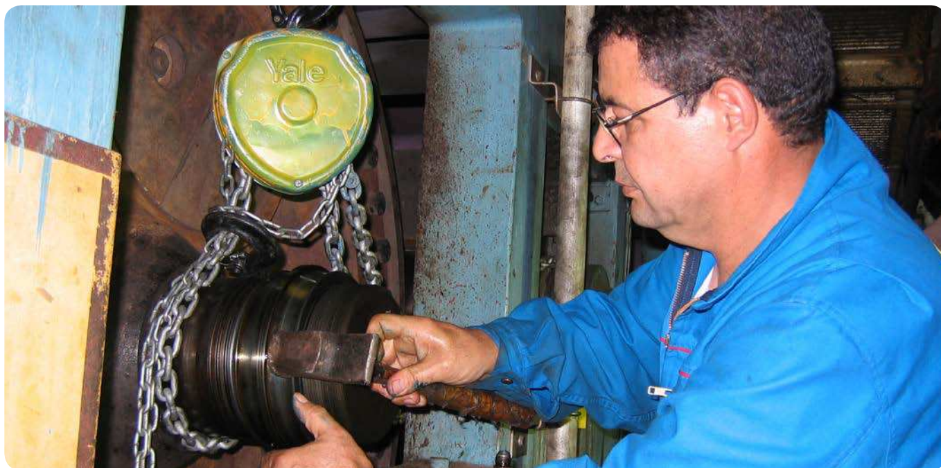
Técnico de SKF comprobando la geometría del asiento del rodamiento con un aro interior y azul de Prusia
