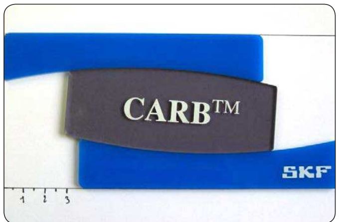
Fig. 5 Con el juego radial que aparece en la figura 4, el posible desplazamiento axial de un aro con respecto al otro es importante. Tenga en cuenta que, bajo ciertas condiciones de funcionamiento, la distribución de la carga a lo largo del perfil del rodillo permite que parte del rodillo escape del camino de rodadura, como se muestra.
