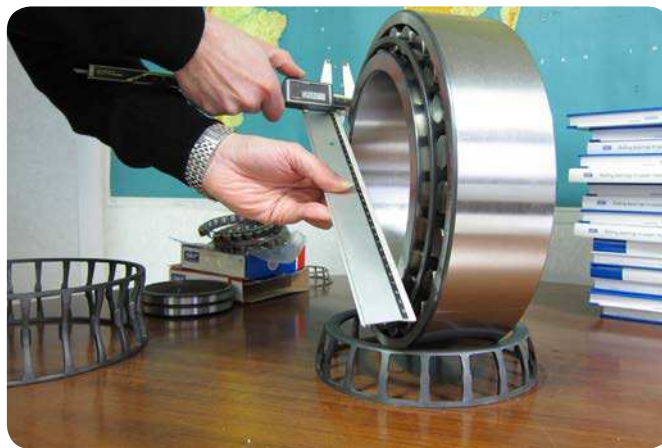
Fig. 7 Uso de una regla y un calibre vernier para medir el descentramiento axial I del aro interior frente al del aro exterior.
