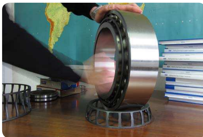
Fig. 9 Giro del aro interior para liberar un rodamiento bloqueado por un desplazamiento axial demasiado elevado.
