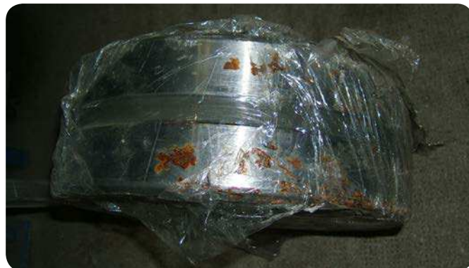
Fig. 3 Rodamiento almacenado con signos de corrosión por humedad.
