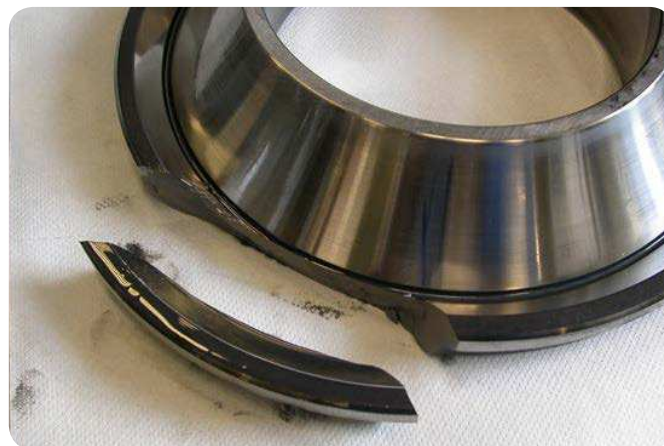
Fig. 1 Rodamiento con arandela de eje fracturada.
