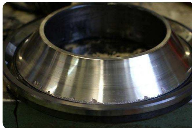
Fig. 2 Rodamiento fabricado de acero mejorado con descascarillado.
