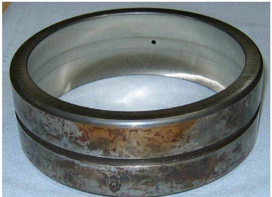
Fig. 1 Corrosión por contacto en el diámetro exterior de un rodamiento de rodillos a rótula
