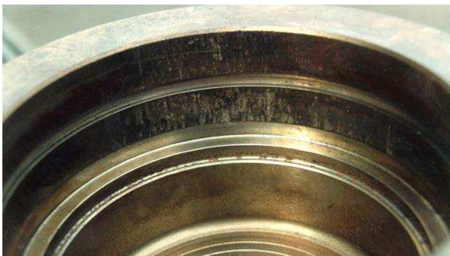
*Fig. 7 Corrosión por contacto en el soporte*
