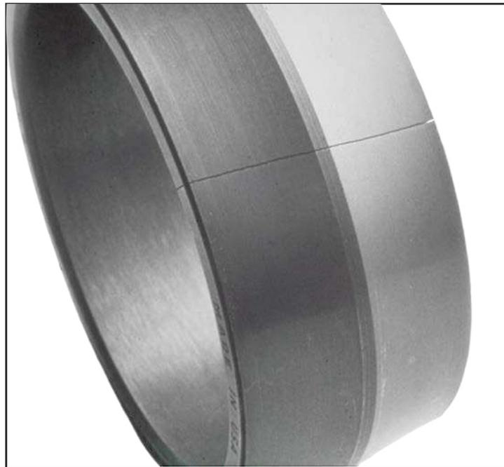
*Fig. 16 El aro interior fracturado de un rodamiento de rodillos a rótula como resultado de un calado excesivo*
