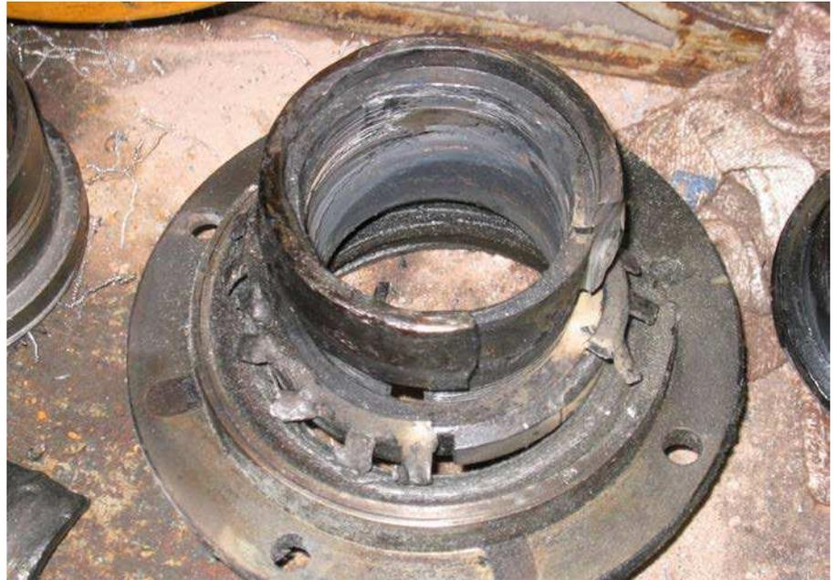
*Fig. 11 Parte del aro interior de un rodamiento en un manguito de fijación después de sufrir un daño importante*
