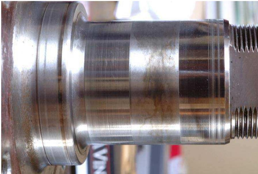
**Fig. 4 Eje con muñón central del rodamiento de rueda, que muestra desgaste en la superficie de contacto con los rodamientos de rodillos cónicos debido a un ajuste flojo y al cambio de sentido de la carga después de 200 000 km**
