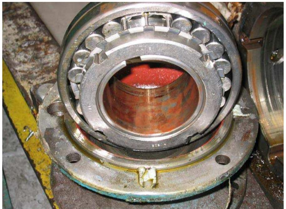
*Fig. 12 Importante corrosión por contacto en el agujero de un manguito de fijación, pero con el camino de rodadura del rodamiento en condiciones bastante buenas, lo que da una pista sobre la causa raíz*
