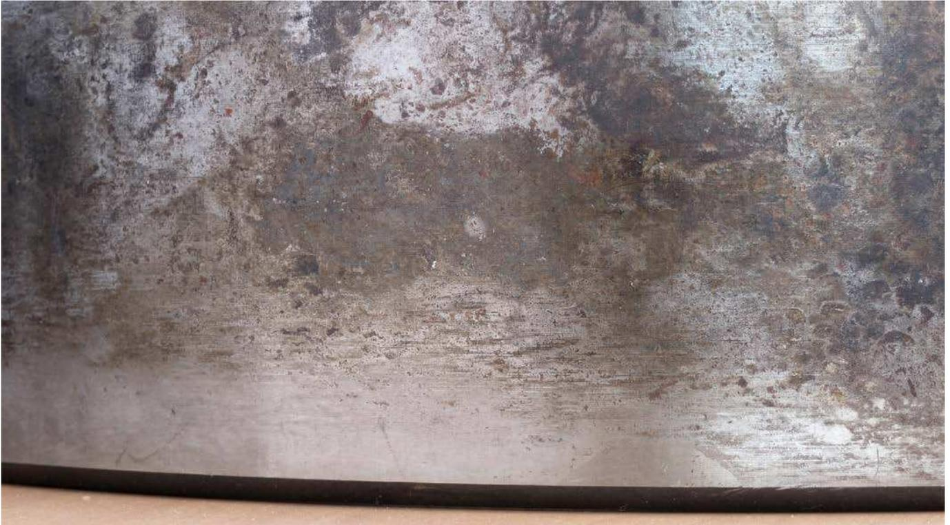
*Corrosión por contacto en la superficie externa del aro exterior de un rodamiento como consecuencia de un camino de rodadura dañado*
