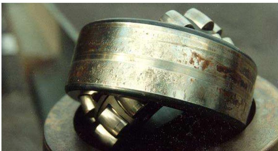
*Fig. 8 Corrosión por contacto en el diámetro exterior del rodamiento*
