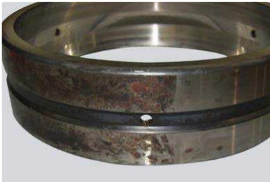
*Fig. 18 Sujeción oval debido a que la tapa no se corresponde con la base en un soporte de pie de dos piezas*
