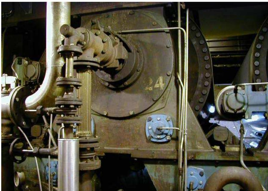
**Fig. 5 Engranajes intermedios en una transmisión del cilindro secador. Tenga en cuenta que las cubiertas azules muestran su posición**
