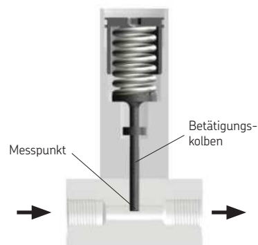
Druckschalter, Messpunkt umspült
