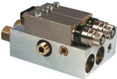
Die Mikropumpe ist eine pneumatisch betätigte Kolbenpumpe. Die über ein 3/2-Wegeventil gesteuerte Druckluft betätigt den Förderkolben, der aufgrund seines Hubes die entsprechende Fördermenge ausschleibt.
